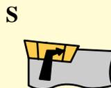
Крепление винтом (винт с торцевальной головкой, винт-эксцентрик)
